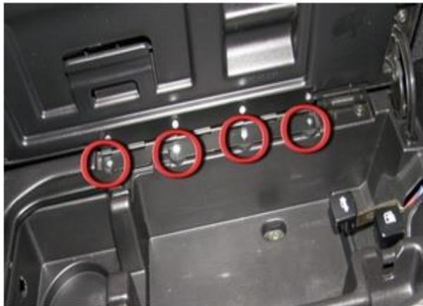
5.) An der Deckelinnenseite (um die Bohrlöcher) müssen nun die Stellen etwas ausgeschnitten werden, damit die U-Scheiben genügend Platz haben um gerade aufliegen zu können.
